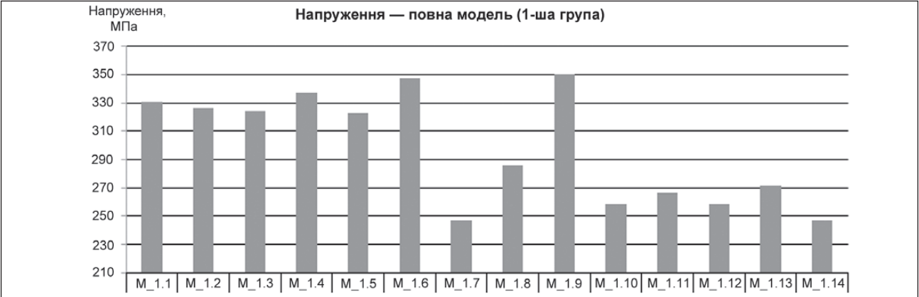
Рисунок 6. Максимальні еквівалентні напруження — повна модель (1-ша група)
